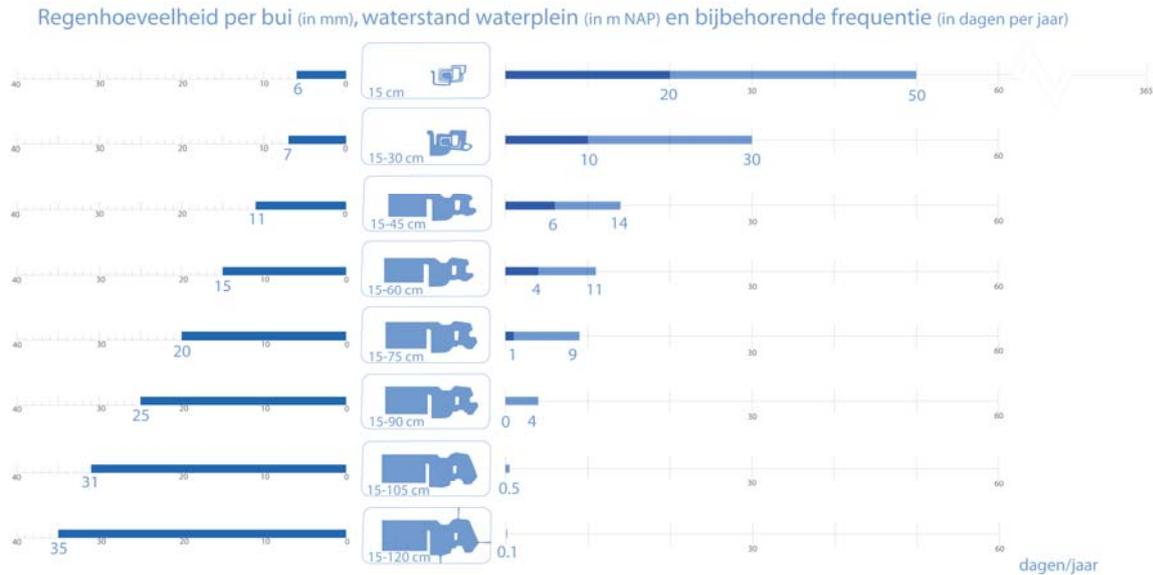
**Abb. B- 2:** Regenmenge und Häufigkeit sind in Relation mit der Wasserhöhe am Platz (Mitte) dargestellt. © Studio Marco Vermeulen/Urban Affairs in Zusammenarbeit mit (i.s.m.) De Urbanisten/VHP
