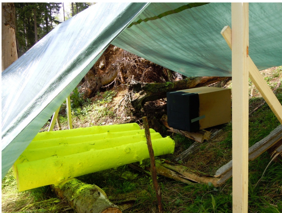
Abb. A-3: Versuchsaufbau: 4 markierte Stammstücke des oberen Stammabschnittes mit Photo-Elektoren und entsprechendem Schutz vor Regen. Wildnisgebiet Dürrenstein, „Hundsau“.
