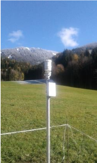
Abb. D-5: Einbau der Wetterstation (METER Group) im Herbst 2019 ca. 200 Meter südöstlich des Versuchsfeldes.
