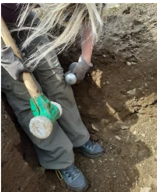
Abb. D-6: Entnahme einer Stechzylinderprobe des Sickerwassersammlers in 60 cm Tiefe (Probenentnahme in 30 cm Tiefe)
