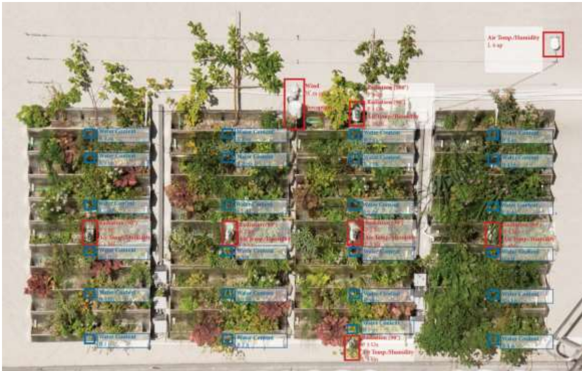
Abb. I-6: Sensorpositionen in und um die grüne Wand; Foto und Darstellung: B. Pucher (2020).
